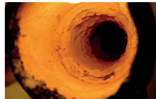
Биоплёнка и органические материалы с течением времени могут накапливаться в линиях поения, что приводит к снижению расхода воды.
