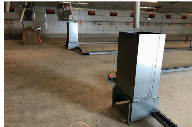
Для увеличения точек поступления корма могут быть добавлены дополнительные бункера.
