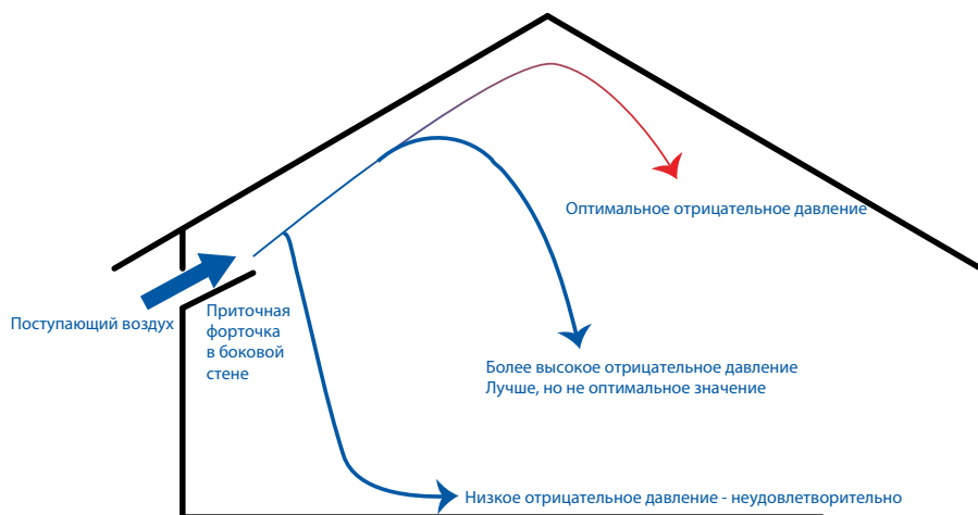
Рис. 104: Использование негативного давления для контроля скорости воздуха.
